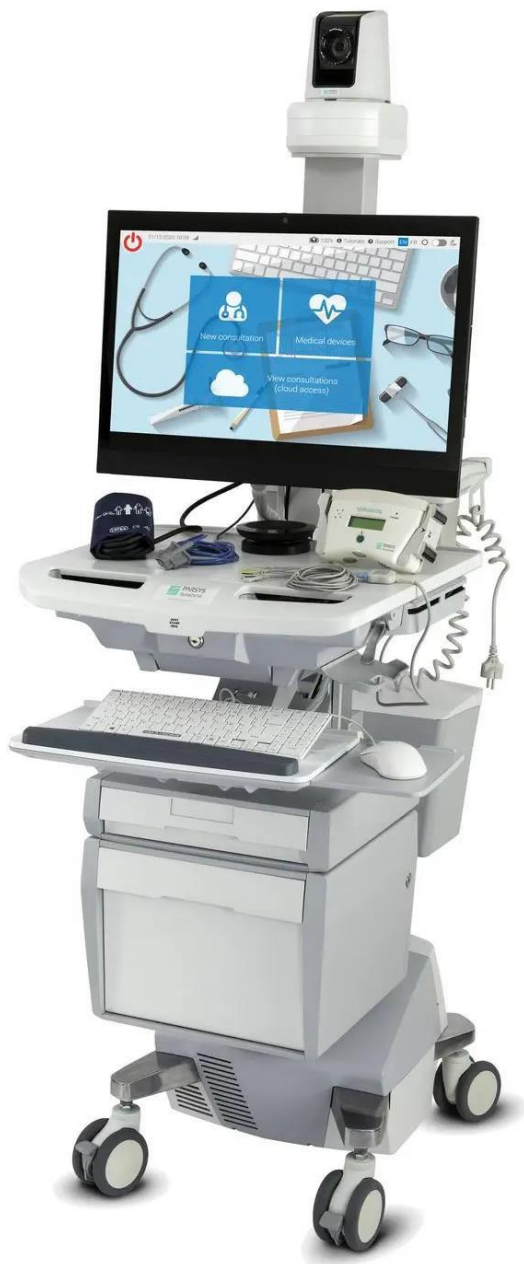
Figura 1 - Modelo de cart de telemedicina: composto por uma Câmera PTZ IP Full HD - Logitech (zoom óptico 10x), Mini PC, 8 GB Ram, processador i5, HD 240 GB (teclado e mouse sem fio), 01 Monitor 24" LED Full HD equipado por audioconferência "Jabra", conexão Wi-Fi
