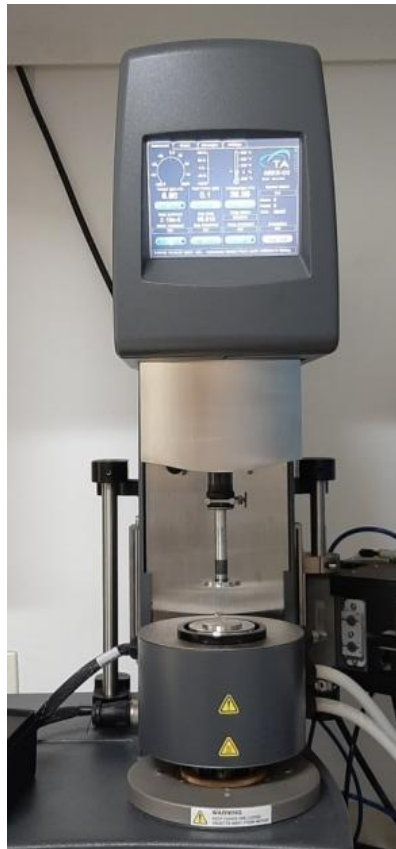
Figura 6: Reômetro ARES-G2 da TA Instruments utilizado para realizar as análises da viscosidade laboratorial.
