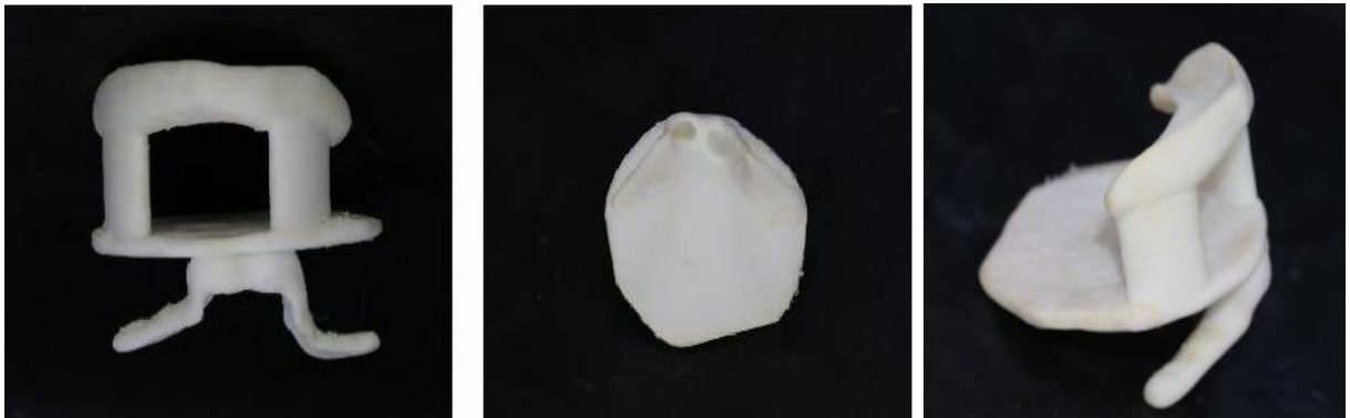
Figura 19: Posicionador Radioterápico Intraoral impresso em PETG Paciente 1.
