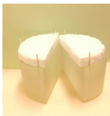
Figura 8: Objeto de simulação de cabeça (Phanton) em PMMA.
