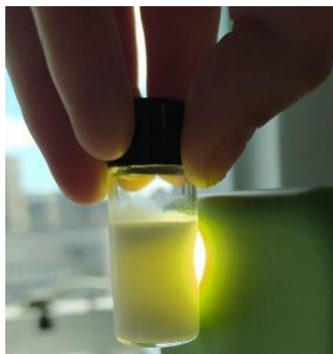
Figura 6 – separação de fases com aplicação de fonte luminosa na formulação 6 da tentativa 1 (5% do mix e 5% do óleo na composição final da emulsão) da CIH.
