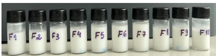
Figura 5 – aspectos visuais das formulações obtidas na tentativa 1 (5% do mix e 5% do óleo na composição final da emulsão) da CIH.
