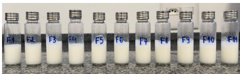
Figura 9 – aspectos visuais das formulações obtidas com a abertura da região formadora de emulsões da CIH (10% do mix e 5% do óleo na composição final da emulsão).
