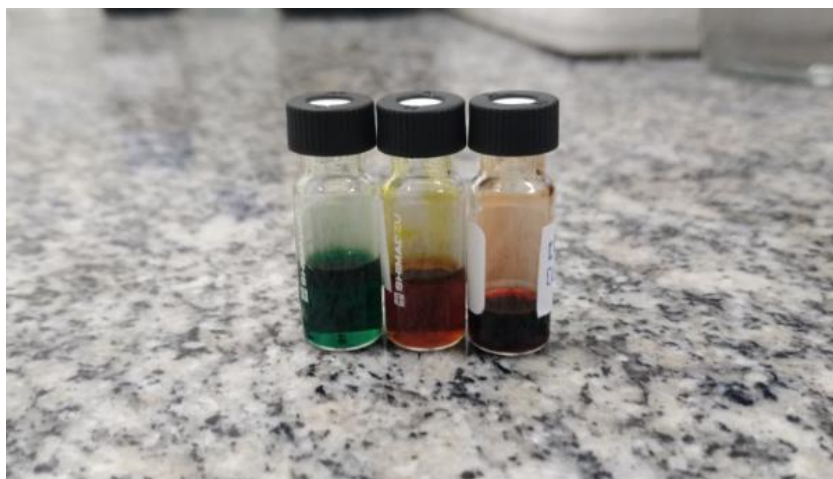
Figura 9: Primeiros MILs sintetizados neste estudo. Da esquerda para a direita ( [P_{6,6,6,14}^+][Ni(II)(hfacac)_3^-] ), ( [P_{6,6,6,14}^+][Mn(II)(hfacac)_3^-] ) e ( [P_{6,6,6,14}^+][Co(II)(hfacac)_3^-] ).
