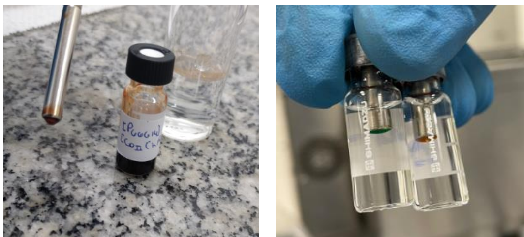
Figura 16. (a) MIL à base de cobalto aderido em um magneto e, (b) MILs à base de níquel e manganês imersos em solução aquosa.
