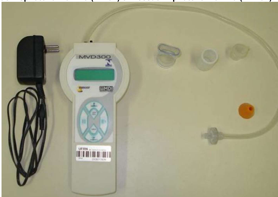
Figura 2 - Circuito do Manovacúmetro digital MVD 300 da Globalmed®, para mensurações da Pressão Inspiratória máxima (PImáx) e Pressão Expiratória máxima (PEmáx).
