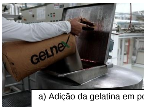
Figura 7. Etapa de Dissolução da matéria-prima: a) Adição da gelatina em pó em um tanque fechado e b) Dissolução da gelatina em pó em água quente.
