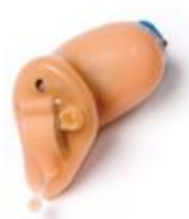
Figura 2 - SpeechEasy modelo intracanal completo
