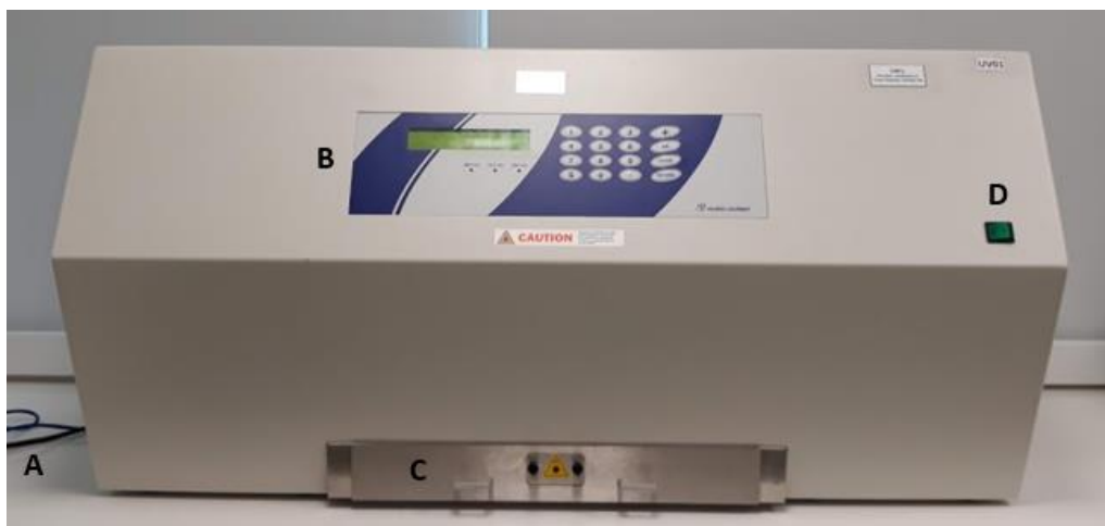
Figura 4 – Foto do Equipamento Bio-Sun. (A) Cabo de energia que deve ser colocado na tomada de 220V. (B) Painel de configuração do equipamento. (C) Bandeja onde deve ser colocada a microplaca de cultivo celular ou placa de petri. (D) Botão liga/desliga.
